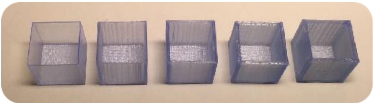
Probekörper mit verschiedenen Wandstärken. Von 1 bis 5 Schichten Wandstärke.
