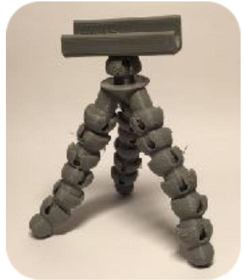
Manchmal ist es von Vorteil einen Körper nicht im Ganzen, sondern in kleineren Einzelteilen zu drucken und mit Sekundenkleber zu verkleben.
