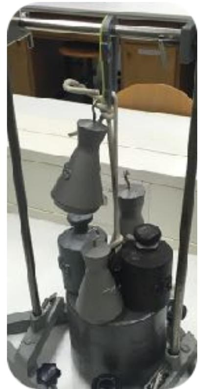
Über 40kg hängen an einem gedruckten Karabinerhaken aus PLA
