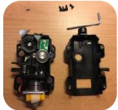
Bei hartnäckigem Filamentstau muss sogar der Extruder von geschultem Personal geöffnet werden.
