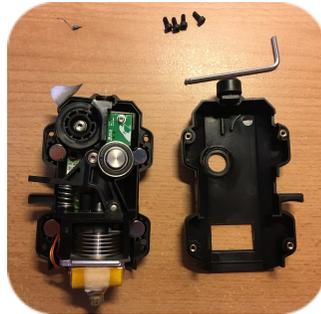
Bei hartnäckigem Filamentstau muss sogar der Extruder von geschultem Personal geöffnet werden.
