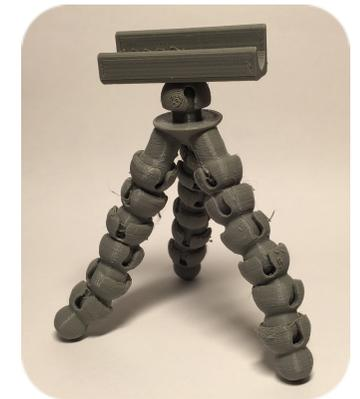
Manchmal ist es von Vorteil einen Körper nicht im Ganzen, sondern in kleineren Einzelteilen zu drucken und mit Sekundenkleber zu verkleben.
