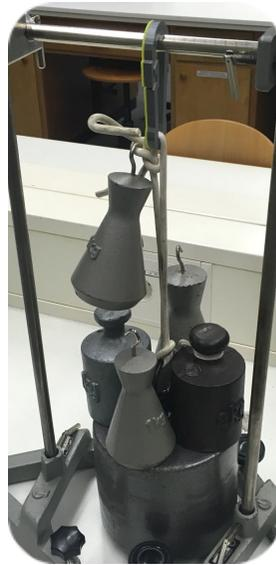
Über 40kg hängen an einem gedruckten Karabinerhaken aus PLA
